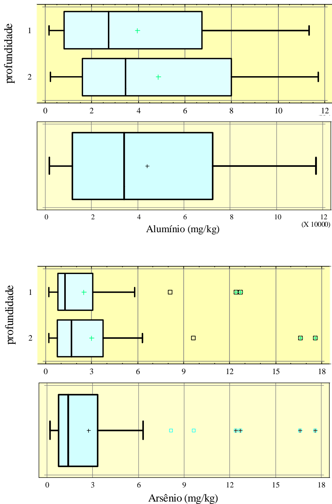
Figura C.1. Gráficos "box-plot", para os metais em amostras de superfície (1), subsuperfície (2) e em conjunto.
