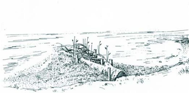
*Troncos de árvores ancorados com estacas para proteção da margem*
