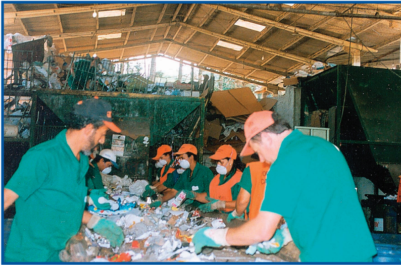
Centro de Triagem Após coletados, os materiais recicláveis são criteriosamente separados por tipo de papel, plástico, vidro e metais. Na foto, centro de triagem em Jundiaí - SP.
